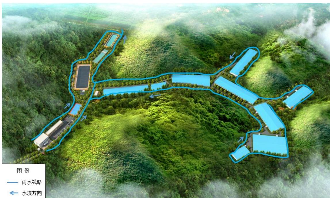
图 4-3 项目雨水管线示意图
