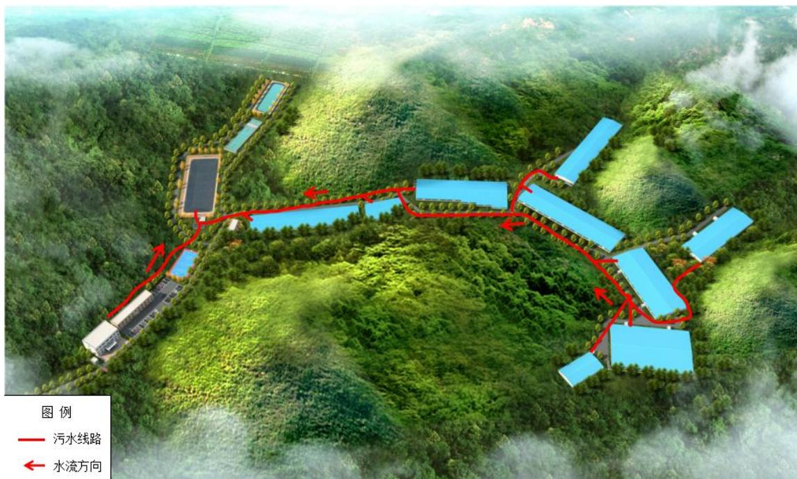
图 4-2 项目污水管线示意图
